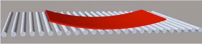
**Bild 03** Die Glasscheibe biegt sich im Ofen, wenn sie ungleichmäßig aufgeheizt wird. Hier im Bild ist die Aufheizung von unten erfolgt.
