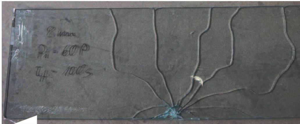
So sieht die Bruchstruktur von teilvorgespanntem Glas in der Praxis aus. Dieser Bruch entspricht der EN-Norm (s.u.).
